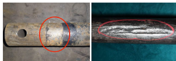
图 2 失效阀杆形貌
